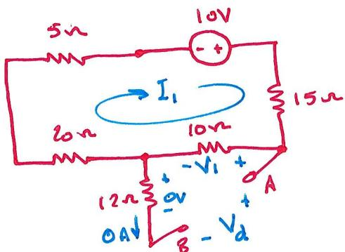
$$I_1 = \frac{10V}{5\Omega + 20\Omega + 10\Omega + 15\Omega}$$
