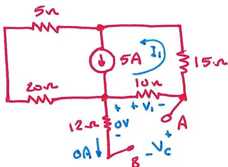
$$I_1 = \frac{5\Omega + 20\Omega}{5\Omega + 20\Omega + 10\Omega + 15\Omega} (5A)$$
